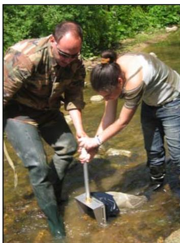
Per l'utilizzo viene messo sul fondo con l'apertura situata contro corrente e davanti a questa si smuove il terreno in modo che l'acqua trascini nel vasetto il materiale sollevato. Poi si svuota il contenuto in una vaschetta di raccolta, dove vengono prelevati i macroinvertebrati e posti in una seconda vaschetta.
